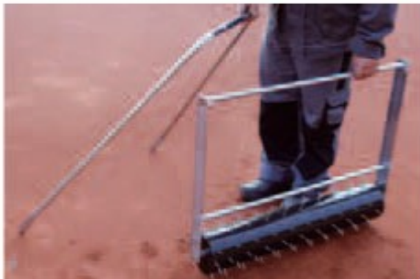
Transportable Gewichtseinheit Eigengewicht der Stachelwalze 22 kg
